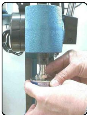
プレスシャンクにロードセルを差し込む
