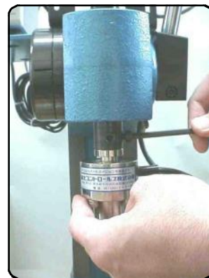
2点のボルトを締め込む
