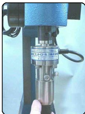
シャンクの端面とロードセルの荷重負荷面をぴったり合わせる
