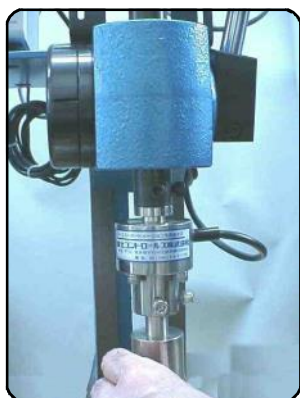
ロードセルのシャンクに治具を差し込む
