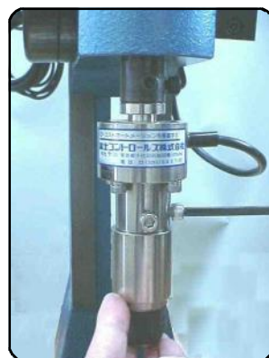
2点のボルトを締め込む
